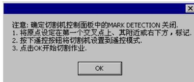
4. 使用切割机前面板上的控制钮，将切割头与第一个自动对齐标记对齐（如果没有标记，则与右下角对齐）。
