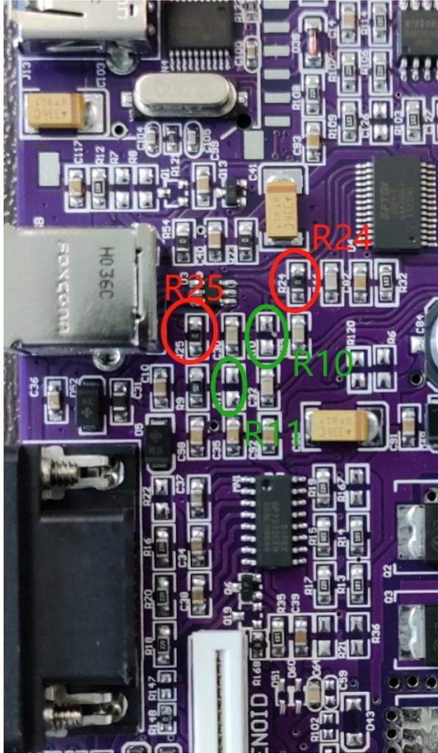
1. 如果 USB 口作为串口使用，需要电阻连接如上图的 R24,R25,, 把 R10,R11 断开，并且主板上要有焊接 FTDI 芯片，主板需要烧串口配套的固件，版本号为 7.XX
