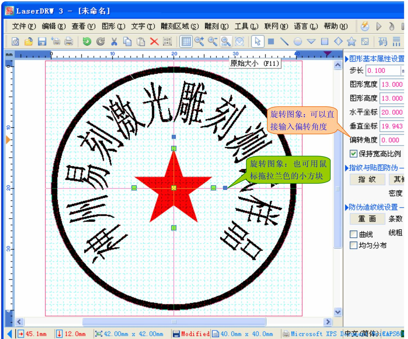
本软件的图象旋转功能，旋转的轴心是图形的中心位置。
