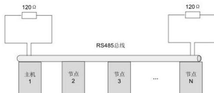
图 8-5 终端电阻的正确接入方式
