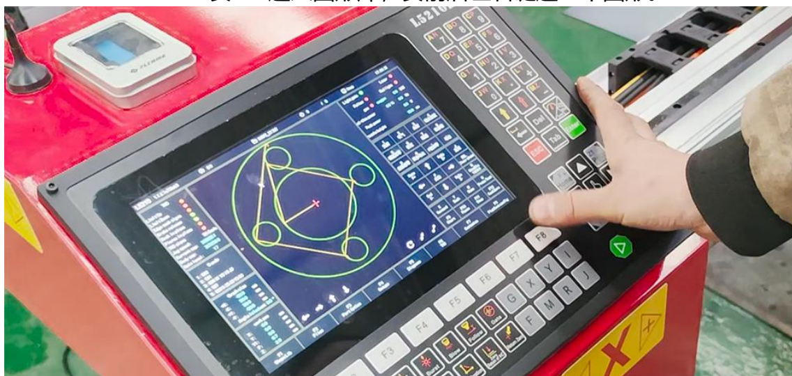
c. 安确定键进入图形尺寸设置，设置完成后安 F8 保存返回主界面。
