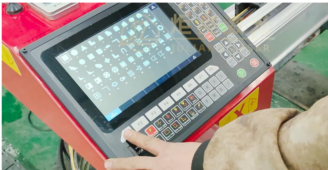
b. 安 F1 进入图形库，安前后左右键选一个图形。
