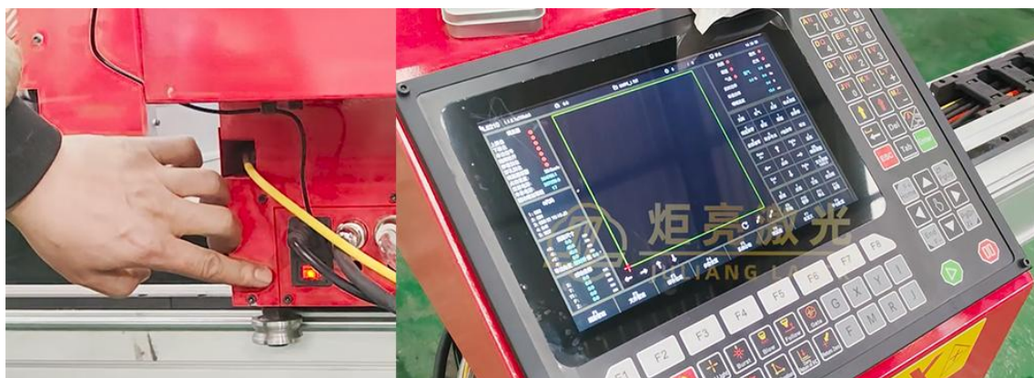
a. 把主机上的电源开关打开，主机屏幕点亮。
