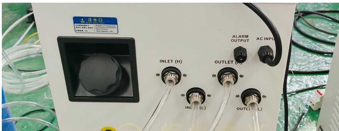
d. 检查并确保冷水机后面的水管接好
