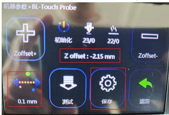
自动检测完成后，打印头自动运行到台面中间，需要提前使用一张 A4 纸放入到台面中间，印头达到台面中间后会下降压到 A4 纸，此时需要到显示操作点击左下角切换进度到 0.1mm，然后通过点击 +/- 符合来校正调节打印头与平台上 A4 纸距离（+是抬高打印头，-是降低打印头）打印头与 A4 纸距离刚好接触到的高度即可。调节 +/- 符合显示屏中间会有数值变化，调整完成后点击保存即可。打印头会自动归零，然后点击返回到主界面就完成调平了。
