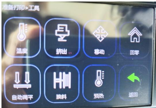
**工具界面：** **温度**点击进入可以预热打印头与平台温度，预热打印头可点击小字母 ABS 一键设定预热到 220°C,预热平台温度需要点击左下角喷头 1 进行切换至热床才可设定平台温度。**挤出**点击进入可以手动控制操作进/退材料，前提需要把打印头预先加热到 200°C 以上才可操作。**移动**点击进入可以手动控制操作机器 X/Y/Z 轴移动。**回零**点击进入可以手动控制机器 X/Y/Z 轴归零，点击 All 是一键归零。**自动调平**（不可直接点击，后面有自动调平教程）是自动检测记录台面平整度，打印工作时自动调节 Z 轴方向高度来到达打印头与台面保持一定高度平齐。**换料**也是需要先预热打印头 200°C 才可操作，与挤出功能一样，此功能很少使用，可以不用操作，如需要可以使用挤出功能代替。**预热**点击进入可以点击 Bed 是加热台面温度到 45°C，点击 PLA 是加热喷头温度到 190°C,点击 ABS 也是加热喷头温度到 210°C，与温度功能一样，也很少使用，可以不用操作，如需要可以使用温度功能代替。
