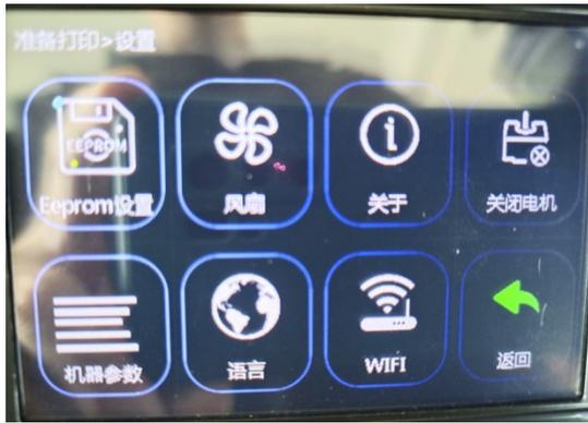
**设置界面：****Eeprom 设置**点击进入是启动自动调平时需要用到的功能，平时不需要点击操作。**风扇**点击进入是手动操作控制打印头左右两侧可控风扇，100%是强力风，50%是中力风，0%是关闭可控风扇，此功能也是很少使用，主要作用是给单独打印小字散热。**关于**点击进入是看主板型号的。**关闭电机**点击是解锁X/Y/Z轴电机的，与工具界面的回零功能里面关闭电机是一样的。**机器参数**点击进入《**机器设置**里面是加速专业设置，不可随意更改**电机设置**里面是脉冲专业设置，不可随意更改；**调平设置**里面(**手动调平坐标设置、自动调平指令设置、挤出头与调平开关偏移设置**)为专业设置，也不可随意更改，(**BL-Touch Probe**)是检测校正打印头与台面高度距离，可以操作更改，此功能用的也很少；**高级设置**里面也是专业设置，不可随意更改》。**语言**点击进入切换显示屏语言，有简体、繁体、英语、俄语、西班牙语、法语、意大利语。**WIFI**功能目前没有开启，不可点击进入操作。
