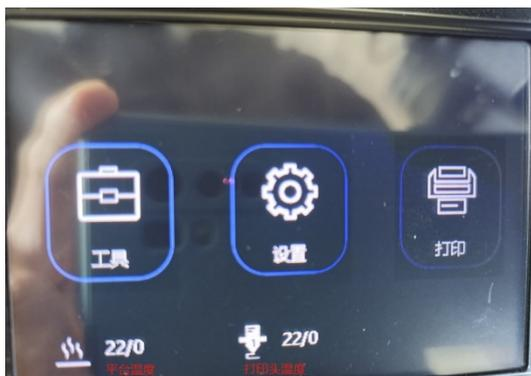
**主界面：**显示平台与打印头温度的左侧显示是实际温度数值，右侧显示是设定温度数值。
