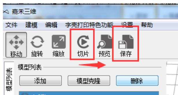
6.切片以后保存到SD卡即可放进3D打印机打印
