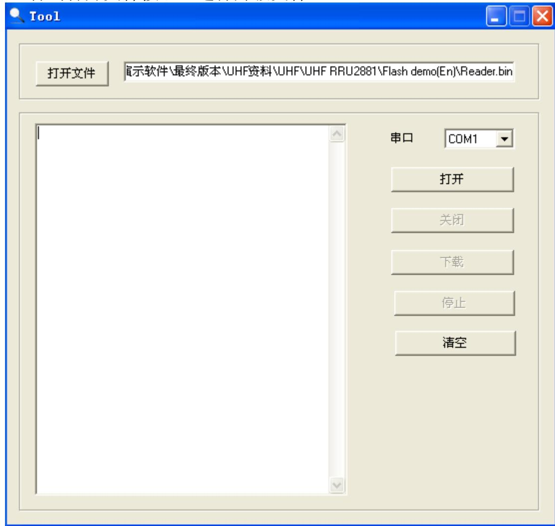
3. 打开连接使用的串口，并点击下载：
