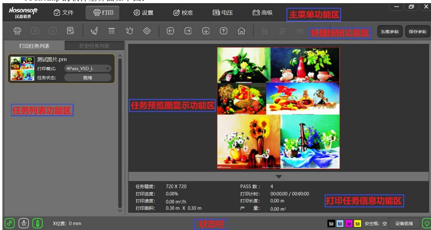
PrintExp 软件主界面主要包括主菜单功能区，快捷按钮功能区，打印列表功能区，任务预览图显示功能区，打印任务信息功能区，状态栏等几大部分，以下分别对这几大部分做介绍。
