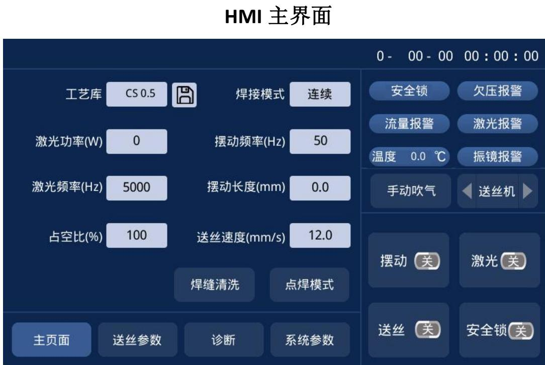
**【摆动关闭】：**通过该按钮可以使振镜电机摆动开启或关闭。
