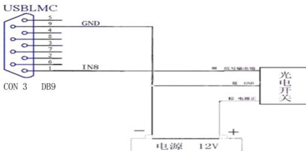
图 2.2.4 NPN 型光电开关与 USBLMC 接线示意图
