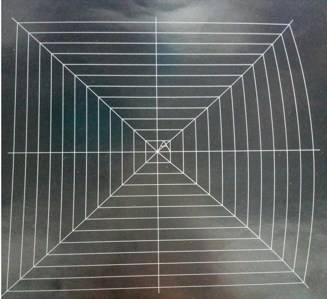
这张图明显可以看出坐标 6 测量的坐标值有明显错误，需重新校正，返回**步骤三**。若图样整体正确，使用直尺或者精度更高的工具来量每根线的间距是否为**5mm**，水平垂直方向均需测量。校正图像测量值应尽量接近 5mm，若误差过大请重新校正。注意：此测量的误差取决于客户要求，一般误差在**±0.1mm**以内。如果不符合客户要求请返回步骤三重新校正。反之继续下一步。
