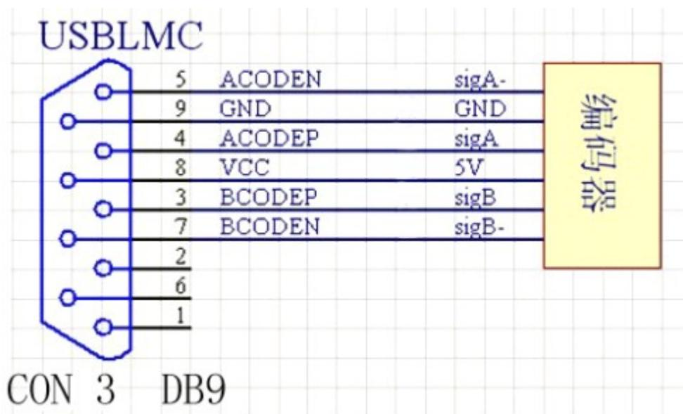
图 2.2.2 编码器与 USBLMC 接线示意图
