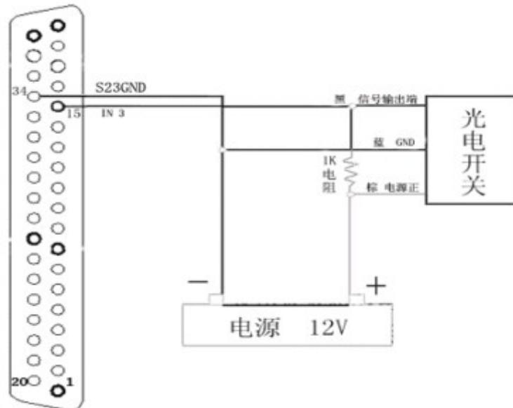
图 2.1.2 NPN 型光电开关接线图
