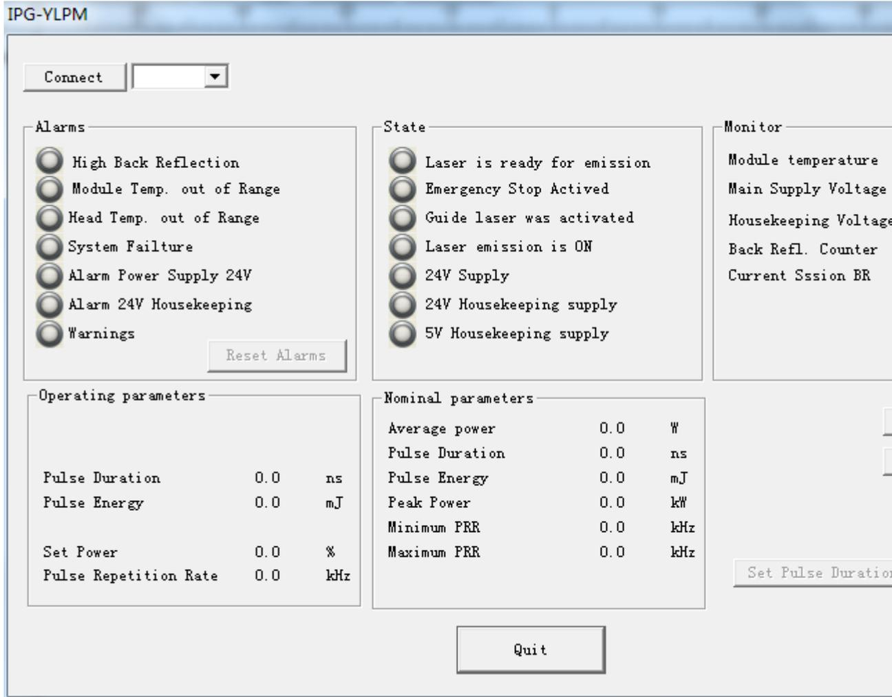
图 7-6 IPG\_YLPM 激光器状态
