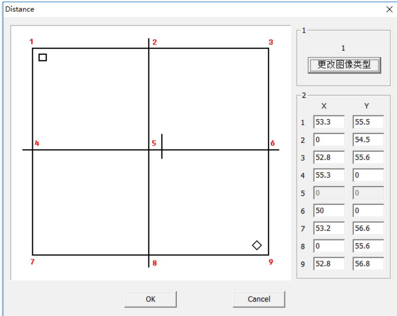
观察对话框显示图像与标刻图案是否一致，若一致，则继续后续步骤。若不一致，点击“**更改图像类型**”，直至软件显示的图形与黑相纸上标刻的图形一致。再根据标刻图形与软件显示的图形所对应的各个点的坐标位置，以**5号点为中心坐标(0, 0)**。使用直尺量取黑相纸上的各点对应坐标，取绝对值（精确到小数点后一位），填入对话框对应坐标栏。做完之后点击“**OK**”返回上级界面。
