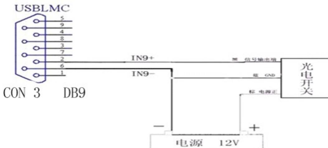
图 2.2.3 PNP 型光电开关与 USBLMC 接线示意图
