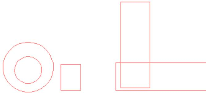
图 3-2 填充对象(左图可以填充, 右图两个矩形相交, 填充结果可能不是所预期的结果)
