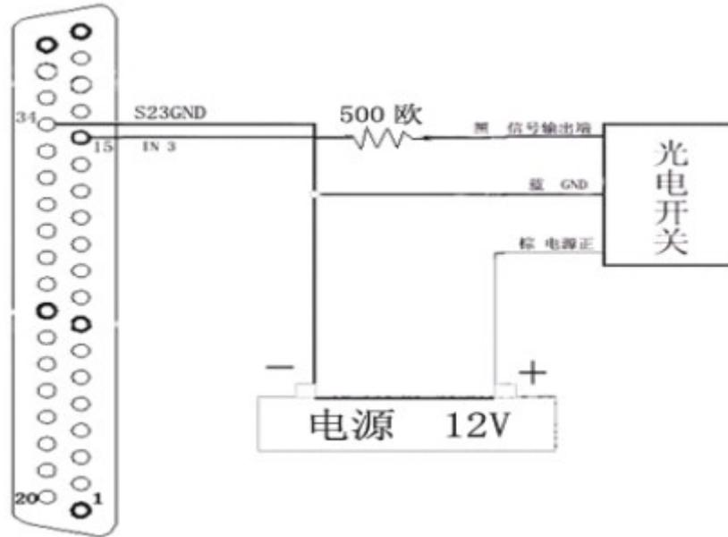
图 2.1.3 PNP 型光电开关接线图
