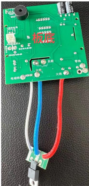
可控硅上的红蓝色线是 14AWG 号线，能过 14A 电流，110V 的能过 1550W，220V 的发热盘能过 3080W 这是我们把线号做大一点，方便你们兼容不同功率的机型
