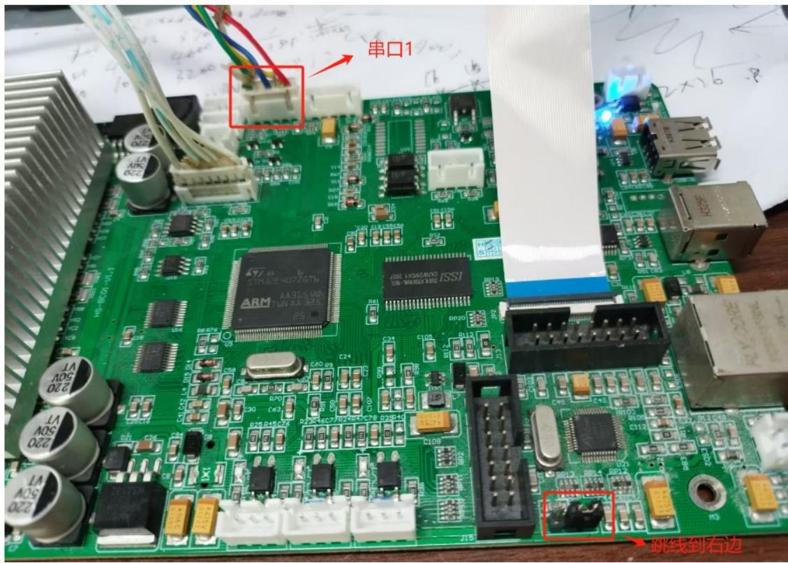
2 打开 Flash Loader Demo 文件夹下的 STMFlashLoader Demo.exe 程序，选择电脑上对应串口。 (try 38400 too)
