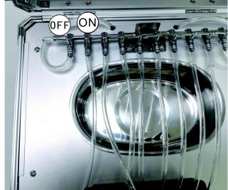
Step5 把喷头的进墨口接上清洗机的冲洗管。
