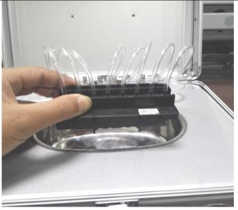
Step12 反复清洗几次,再按干净的清洗液清洗。直到冲洗时,从喷孔里射出的清洗液整齐,干净后,把喷头清理干净,重新安装上打印机即可。
