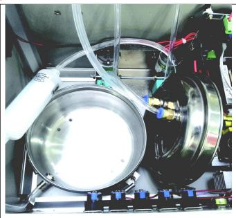
Step2 往清洗液存贮罐中倒入清洗液,最少量要没过罐子的出水口。
