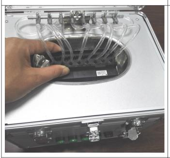
Step11 把喷头喷嘴浸入液面 2mm,开启超声波清洗,开启时间约 30 秒后关闭,休息 3 分钟再开启 30 秒。超声波循环开启不要超过 5 次。
