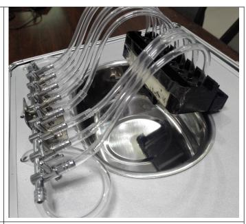
Step10根据清洗喷头的情况慢慢地旋转流量控制旋钮,以免冲坏喷头。反抽操作要把喷头喷嘴浸入液面 2mm。
