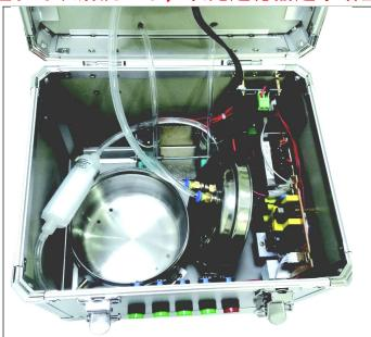
Step1 打开机器底盖,及清洗液存贮罐盖子。
