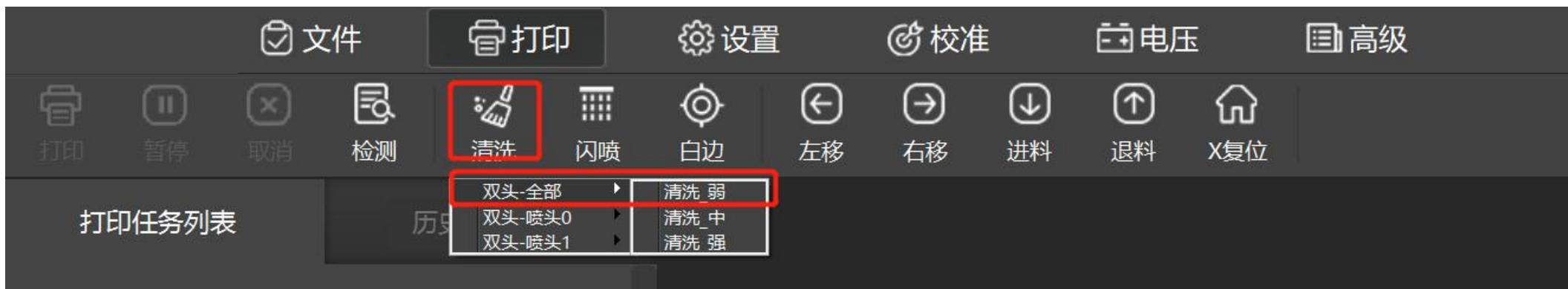
由于白墨的特性，若打印机长期不打印，喷头容易堵塞，即使当天没有打印任务，也要进行1-2次的喷头清洗，保证喷头不被堵死，最久不超过3天
