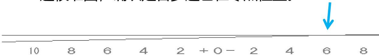
3. 如还不在“0”点位置，再根据打印的校准图进行加减，直至校准到“0”点为止
