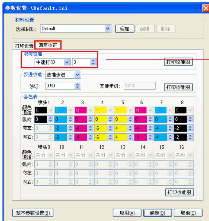
打印测试图查看在什么数值垂直，然后在原有的数值基础上进行加减操作，输入完后点“应用”，再打印测试图查看，直到 0 的位置垂直为止。
