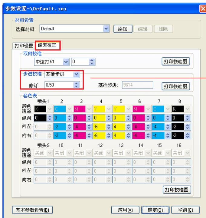
打印测试图查看在什么数值重叠, 然后在原有的数值基础上进行加减操作, 输入完后点“应用”, 再打印测试图查看, 直到0的位置重叠为止。
