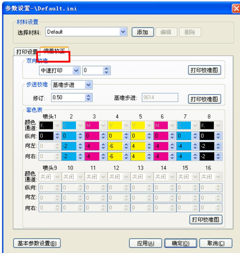
双向校准: 喷头小车来回打印的位置是否在同一起点(可选低速打印、中速打印、高速打印, 在选择三种速度进行打印图像时, 三种打印速度都必需校准)点击“打印校准图”如下图所示:
