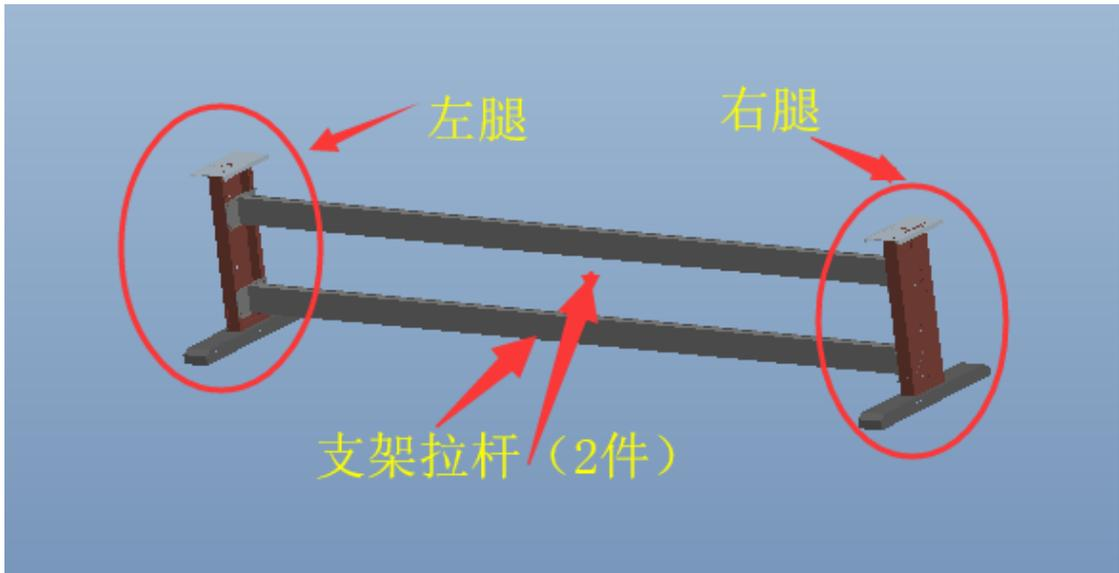
4. ‘支架拉杆’与‘左，右腿’固定孔位，（图2红圈可不用固定）。
