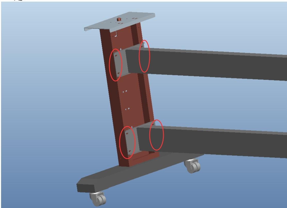
5.到此步时安装效果如图3,将机头抬起,对准‘左,右腿’上的凸点放入。再从‘左腿连接板’从向上打螺丝与机头固定。
