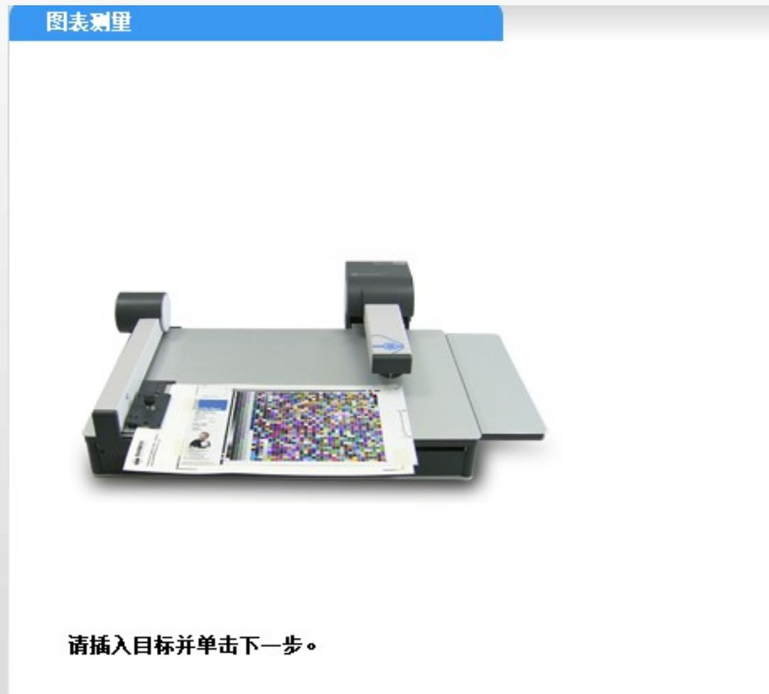
17. 扫描完成之后打开测量文件夹，找到对应作业名字的 mxf 文件复制到一个容易找到的文件夹里面，因为 Gateway 只是扫描，不能生成 icc，所以得到测量数据就可以了，下一步要回到 I1profile 里面。
