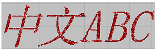
图 7-3 设定切斜角度为 15 度后的针迹效果
