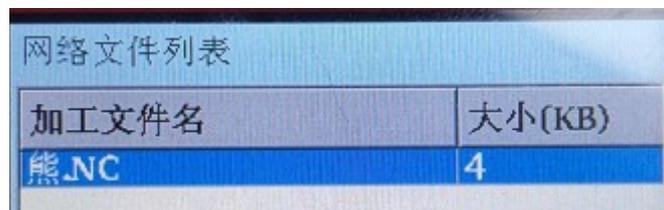
可以按确定拷贝文件到系统内部，下一步可以返回到文件加载目录找到导入的网络文件，在这里完成装载及加工操作。
