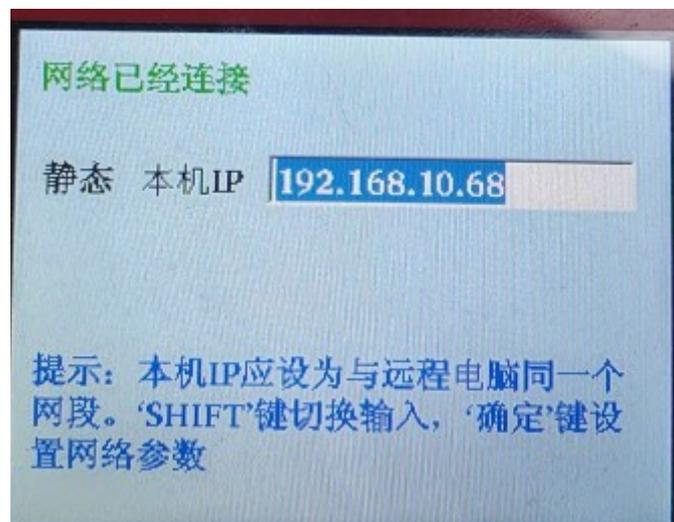
手柄 ip 设置，按” shift”设置 ip，按确定后可查看连接状态是否连接成功，注意：必须保证网线插好的前提。
