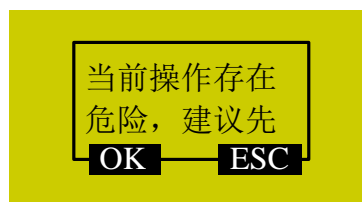
图 5-6 回机械原点操作危险提示
