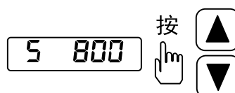
图 7.9 速度试运行操作框图
